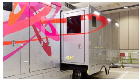
駐車時に車幅が拡幅することでスペースを確保
